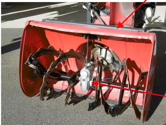
除雪作業中に異物などを噛み込み、オーガのロックボルトが折れた時は、**必ずエンジンを切り**、鍵を抜き取ってからロックボルトの交換を行う
