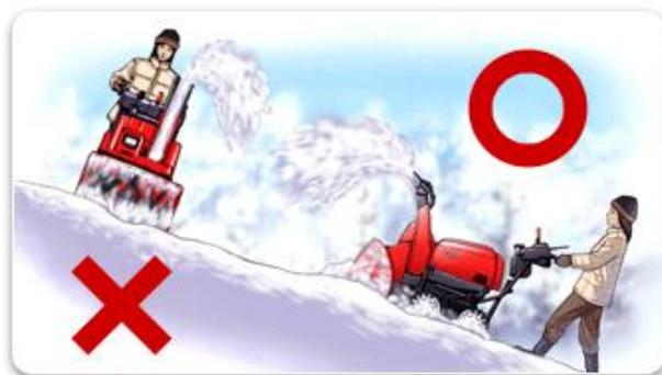
傾斜面を横切って除雪すると、横滑りすることがあります。雪の上での作業は滑りやすく、転倒するおそれがあります。滑りやすい場所では、必ず低速で運転してください。
